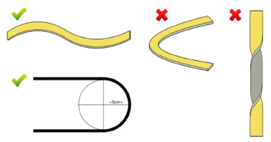
Kabel und Stecker sollten nicht gedehnt werden. Auch sollte der LED-Streifen nicht verdreht werden. Der LED-Streifen ist vollständig vergossen und für eine vielseitige Verwendung konzipiert. Er kann auf verschiedene Arten montiert werden und funktioniert sowohl horizontal als auch vertikal. Bei der Montage des LED-Streifens ist es wichtig, dass die Verkapselung intakt bleibt. Wir empfehlen die Verwendung der folgenden Arten von Montagematerial:
